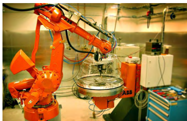
Figure 1.5 – Dispositif d'inertage gazeux global [34].
