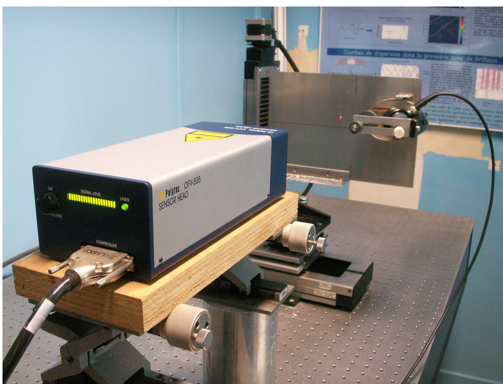
Figure 82 Photographie du dispositif expérimental avec le système sabot+transducteur.
