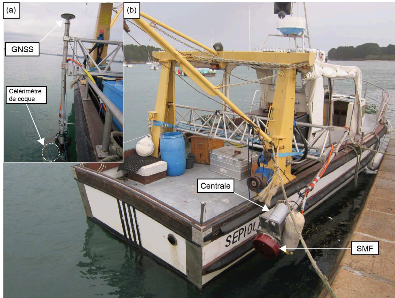
Figure 2.23 Système d'acquisition SMF monté sur le Sériola. La vue d'encart (a) est prise depuis l'avant du bateau.
