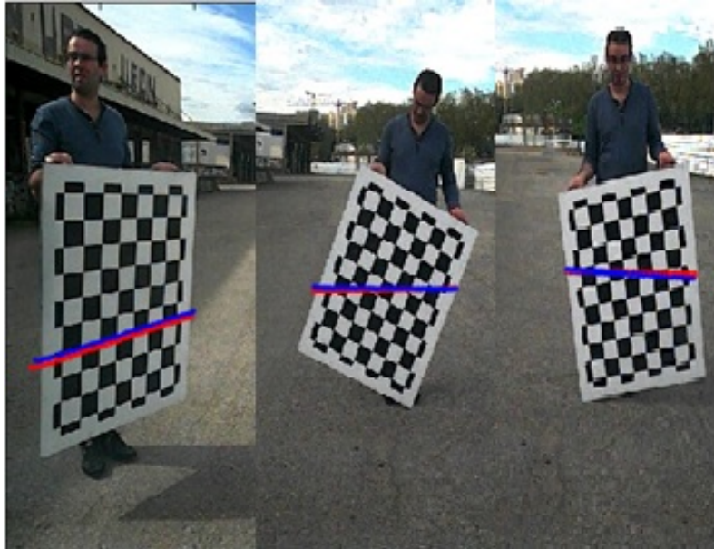
FIGURE III.14: Projection des points LIDAR sur la mire de calibration (Les lignes rouges : solution initiale, Les lignes bleues : la solution optimisée)
