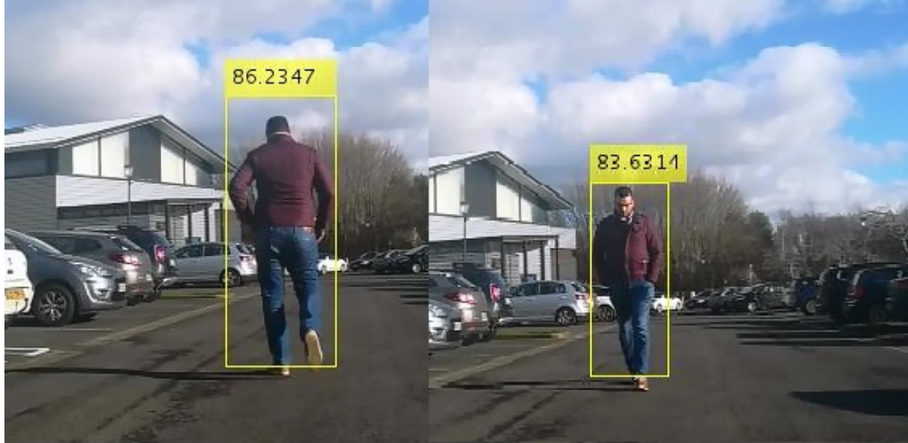
FIGURE IV.5: Détections de piéton avec le détecteur ACF
