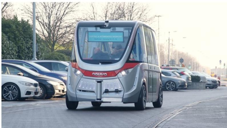
FIGURE I.1: La navette autonome ARMA de la société Navya
