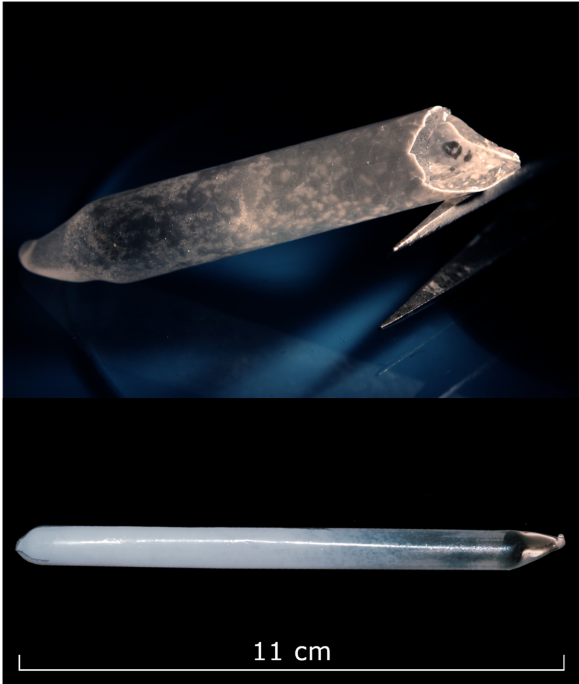
Figure 7.1: Photographies d'un tube silice à la sortie du four. La photo du haut montre un tube qui a été ouvert, son diamètre est d'environ 1cm, on peut voir les dépôts blancs sur sa paroi interne; la photo du bas montre un tube complet dont la paroi externe s'est totalement opacifiée à la trempe
