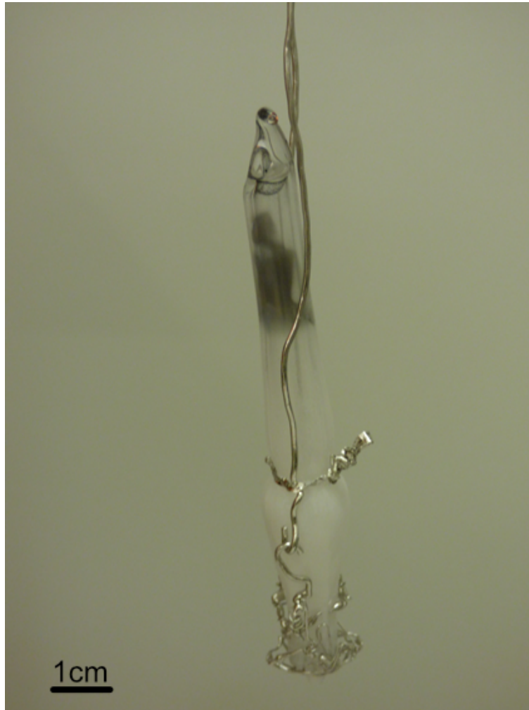
Figure 2.2: Photographie d'un tube dans sa nacelle de platine après la sortie du four, on peut voir que le verre est blanchi dans la zone basse et présente des dépôts sombres vers le haut
