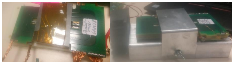
Figure R 32: Le transformateur planar développé pour le convertisseur à trois entrées/sorties.
