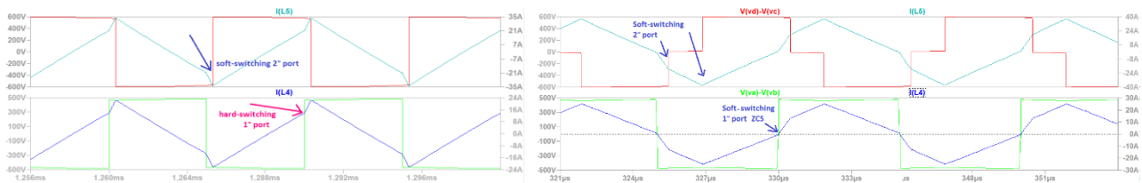
Figure R 8: a) V_{oB} = 600\text{ V} , V_{oA} = 450\text{ V} avec commutation dure sur le pont A. b) Réglage du rapport cyclique D_b pour obtenir des commutations douces sur le pont A.
