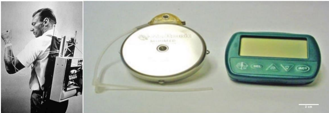
Figure 3: Exemples de pompes à insuline a/ dispositif développé par Arnold Kadish [9] ; b/ DMI commercialisé par Medtronic [10]
