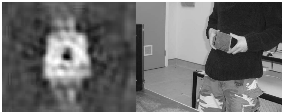
FIGURE 1.22 – Image passive à 22 GHz (gauche) en en environnement indoor d'un individu dissimulant un carré de 10 cm de film de métal sous ses vêtements. Une photo de l'objet en métal non dissimulé (droite). [67].
