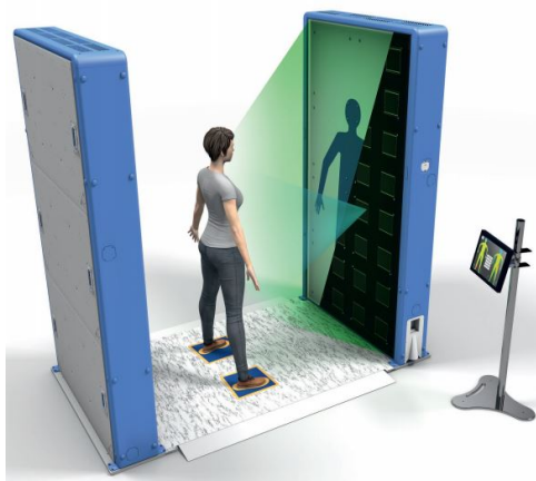
FIGURE 1.14 – Système d'imagerie actif développé par Rohde & Schwarz [64].
