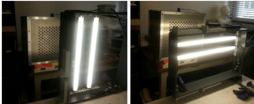
FIGURE 1.58 – Photographie des scènes à imager. Deux lampes fluorescentes espacées de 11 cm [123].
