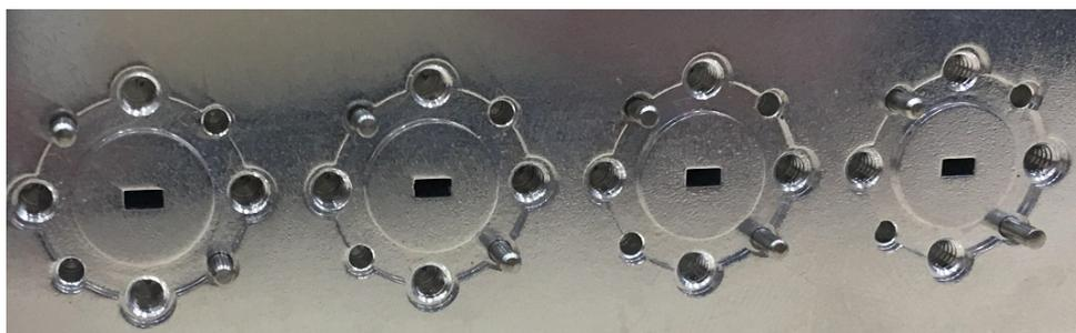
FIGURE 3.7 – Alignement de connecteurs WR-10 standards permettant de comparer les dimensions des guides d'ondes ( $2.54 \text{ mm} \times 1.27 \text{ mm}$ ) à celles des embases (1.9 cm de diamètre) utilisées pour assurer des contraintes mécaniques suffisantes.
