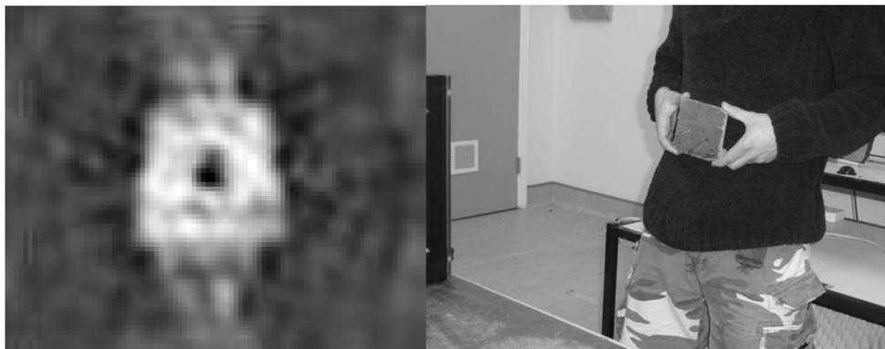
FIGURE 1.22 – Image passive à 22 GHz (gauche) en *en environnement indoor* d'un individu dissimulant un carré de 10 cm de film de métal sous ses vêtements. Une photo de l'objet en métal non dissimulé (droite). [67].
