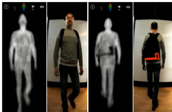
FIGURE 1.26 – Exemple d'images radiométriques d'une personne en mouvement.
