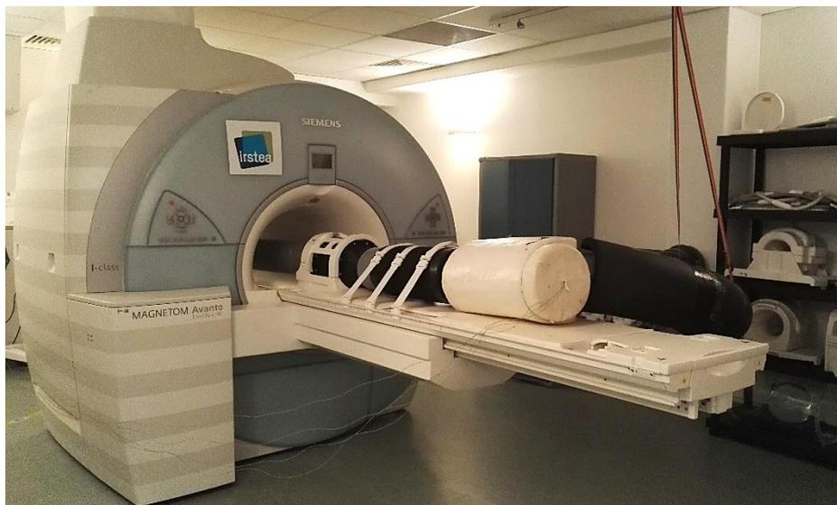
Figure 2-1: Imageur (1.5T, Avanto, Siemens) avec le dispositif de régulation thermique
