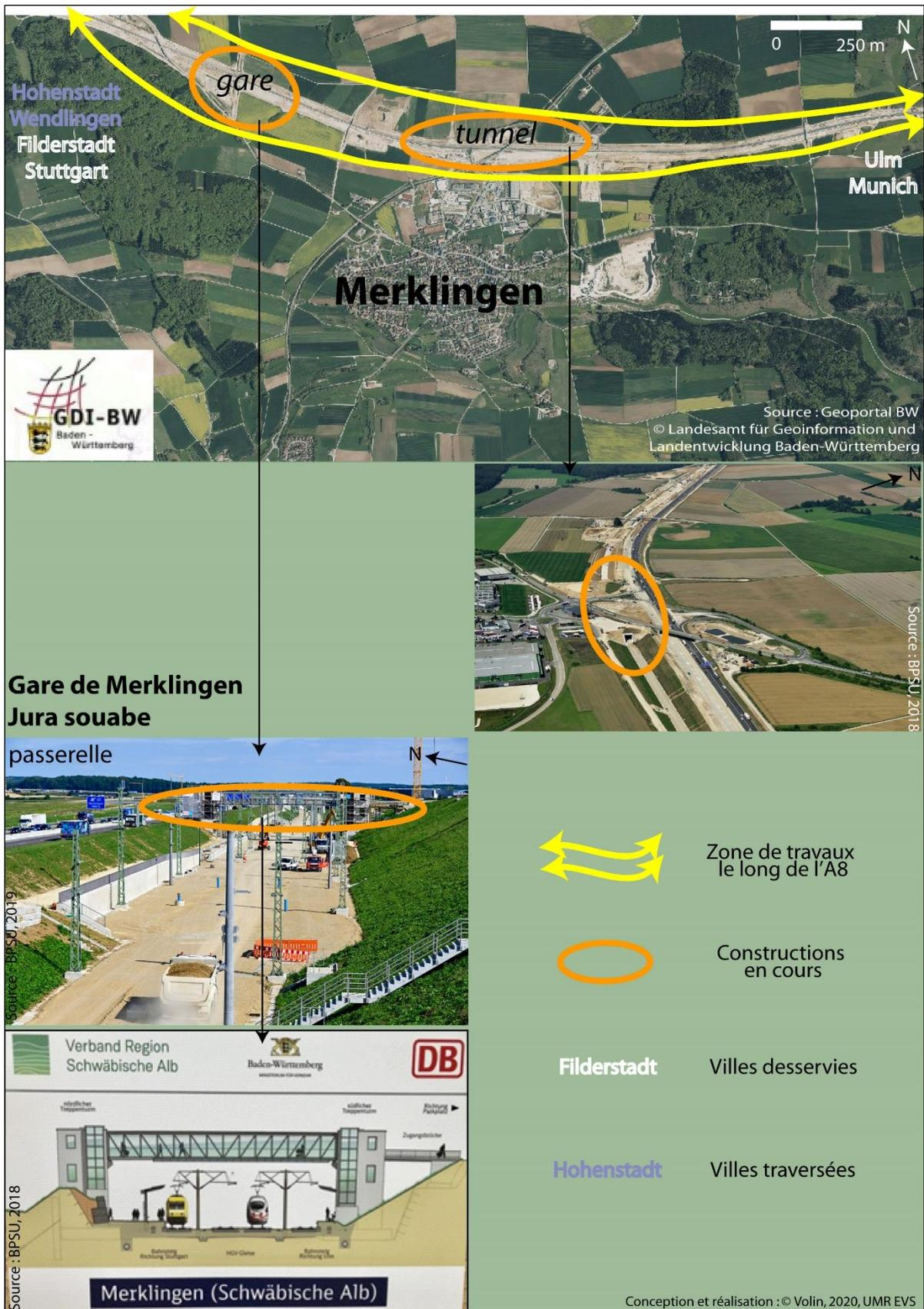
**Figure 55 :** Travaux de construction de la nouvelle gare et du tunnel ferroviaire dans la commune de Merklingen
