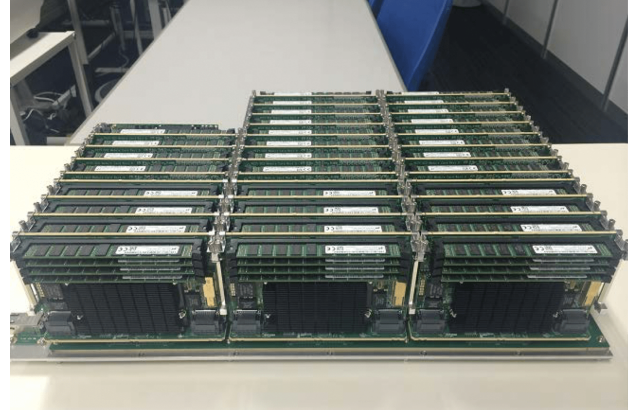
(b) Plusieurs PEZY-SC2 peuvent être connectés sur un serveur.
