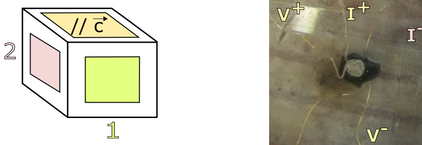
FIGURE 3.32 – (à gauche) Schéma représentant les trois faces étudiées de l'échantillon définissant une configuration transverse (parallèle à \vec{c} ) et deux configurations longitudinales (selon (\vec{a}, \vec{b}) ) annotées 1 et 2. (à droite) Photo de l'échantillon prise sous microscope avec un grossissement x40. Sur la photo on indique la configuration des fils permettant de mesurer la conductance pour la configuration transverse.
