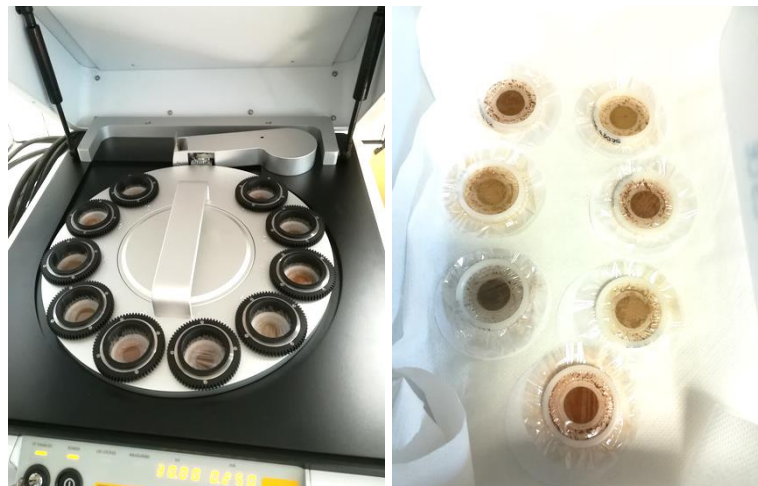
Figure 2.18 : Photographies de l'appareil de fluorescence X à énergie dispersive (ED-XRF) à gauche et des échantillons analysés en cellule SMH (Sources : V. Sellier)
