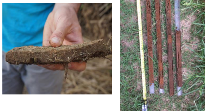
Figure 2.13 : Photographies d'une laisse de crue (Cyclone Cook, 2017) et carotte sédimentaire prélevées sur le bassin versant de Thio (Sources : V. Sellier & O. Evrard)
