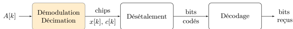
FIGURE 4.4 – Illustration des étapes de démodulation et de décimation dans un schéma bloc simplifié de la chaîne de traitement numérique en bande de base.
