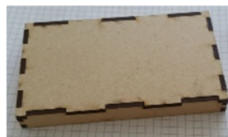
FIGURE 5.7 – Partie supérieure boîte
