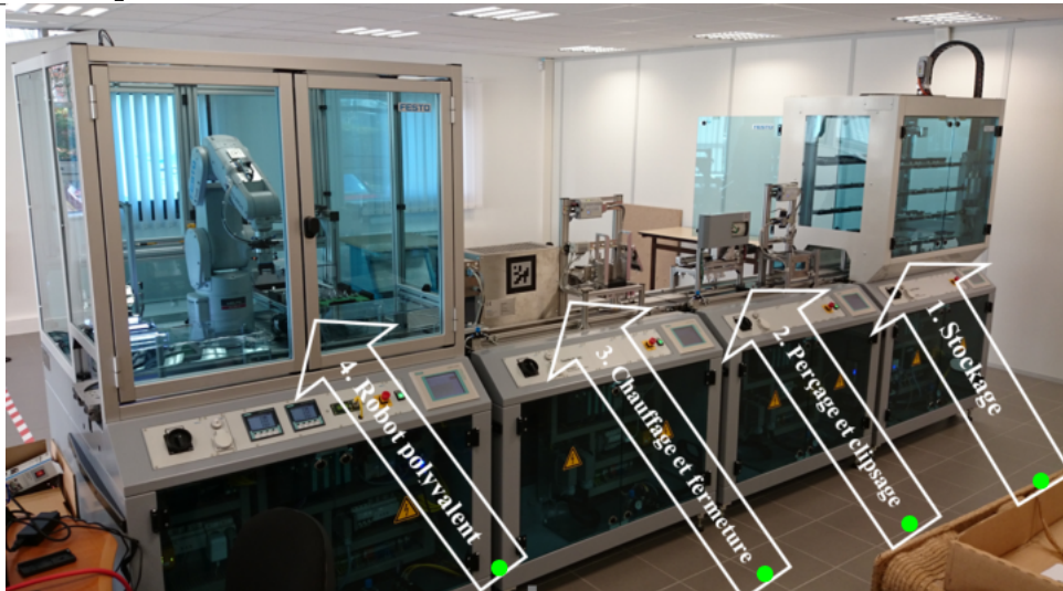
FIGURE 5.4 – La chaîne automatisée et ses modules
