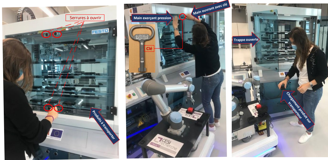
FIGURE 2.21 – Processus de chargement des produits finis du démonstrateur du futur au Laboratoire LINEACT-CESI
