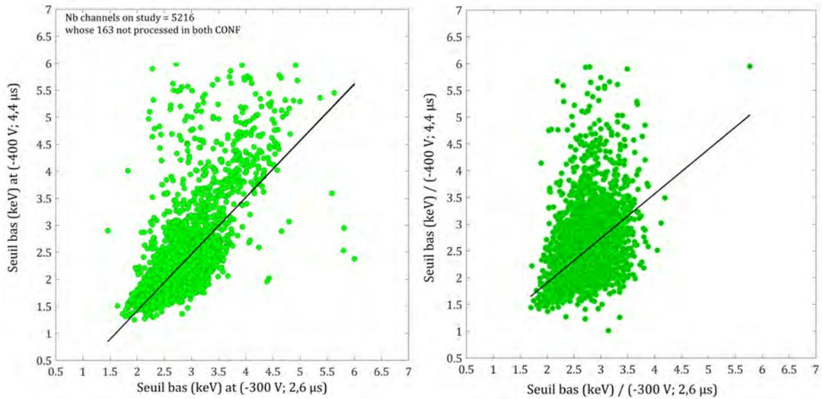
FIGURE 5.30 – Seuil bas en énergie de modules XRDPIX FM de la série 2 (5216 voies détecteurs) : Configuration  $(-400\text{ V}; 4,4\ \mu\text{s})$  versus configuration  $(-300\text{ V}; 2,6\ \mu\text{s})$  - Graphe de gauche : seuils bas calculés à partir de spectres de  $^{241}\text{Am}$  / Graphe de droite : seuils bas calculés à partir de spectres de bruit (sans source radioactive).
