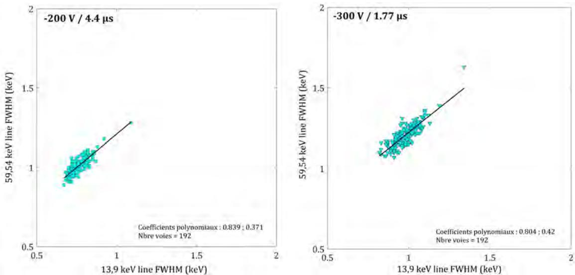
FIGURE 5.26 – Graphe de gauche : FWHM du pic à 60 keV en fonction de la FWHM du pic à 14 keV, dans la configuration (−200 V ; 4,4  $\mu\text{s}$ ) / Graphe de droite : FWHM du pic à 60 keV en fonction de la FWHM du pic à 14 keV, dans la configuration (−300 V ; 1,8  $\mu\text{s}$ ) - Six modules XRDPIX mesurés à −20°C.
