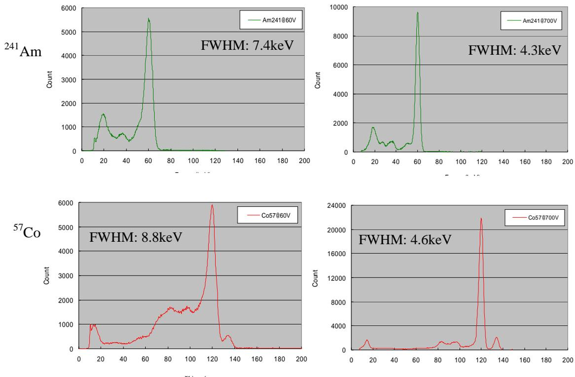
FIGURE 2.22 – Spectres en énergie obtenus par des détecteurs CdTe ACRO RAD. Graphes de gauche : Détecteur CdTe de type ohmique polarisé à  $-60$  V, de résistivité à  $+25^{\circ}\text{C}$  égale à  $1,8.10^9 \Omega.\text{cm}$  / Graphes de droite : Détecteur CdTe de type Schottky polarisé à  $-700$  V, de résistivité à  $+25^{\circ}\text{C}$  égale à  $3,7.10^{11} \Omega.\text{cm}$ , soit un CdTe Schottky 200 fois plus résistif qu'un CdTe ohmique. Credit ACRO RAD
