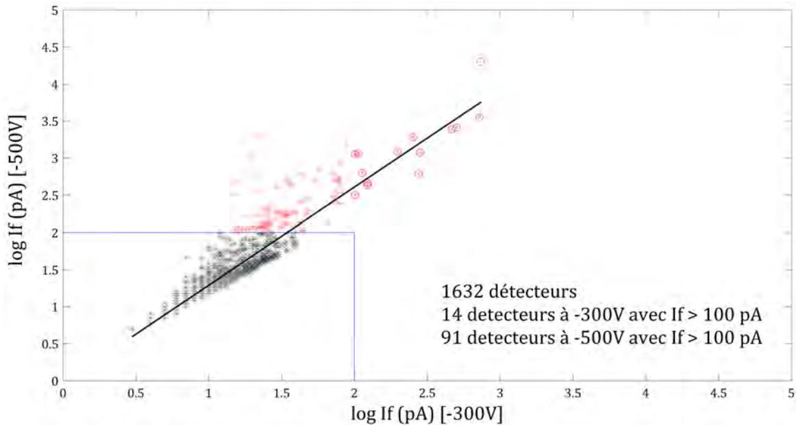
FIGURE 5.8 – Courants de fuite de 51 Céramiques Détecteurs FM polarisées à  $-300\text{ V}$  (abscisse) et à  $-500\text{ V}$  (ordonnée) - Mesures effectuées avant la phase de dégazage sur 1632 voies - Les points en rouge sont hors cadre défini pour un courant de  $100\text{ pA}$
