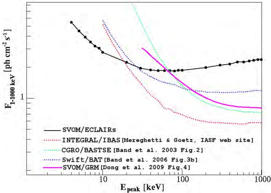
FIGURE 3.18 – Sensibilité de l'instrument ECLAIRS (en noir) à un sursaut d'une durée de 1 s en fonction de l'énergie maximale  $E_{peak}$ , caractéristique du sursaut. La sensibilité est mesurée dans la gamme d'énergie [1 - 1000] keV. L'instrument est plus sensible que *SWIFT* / BAT pour la détection des sursauts mous ayant une énergie  $E_{peak}$  inférieure à 30 keV [Mandrou et al., 2008].
