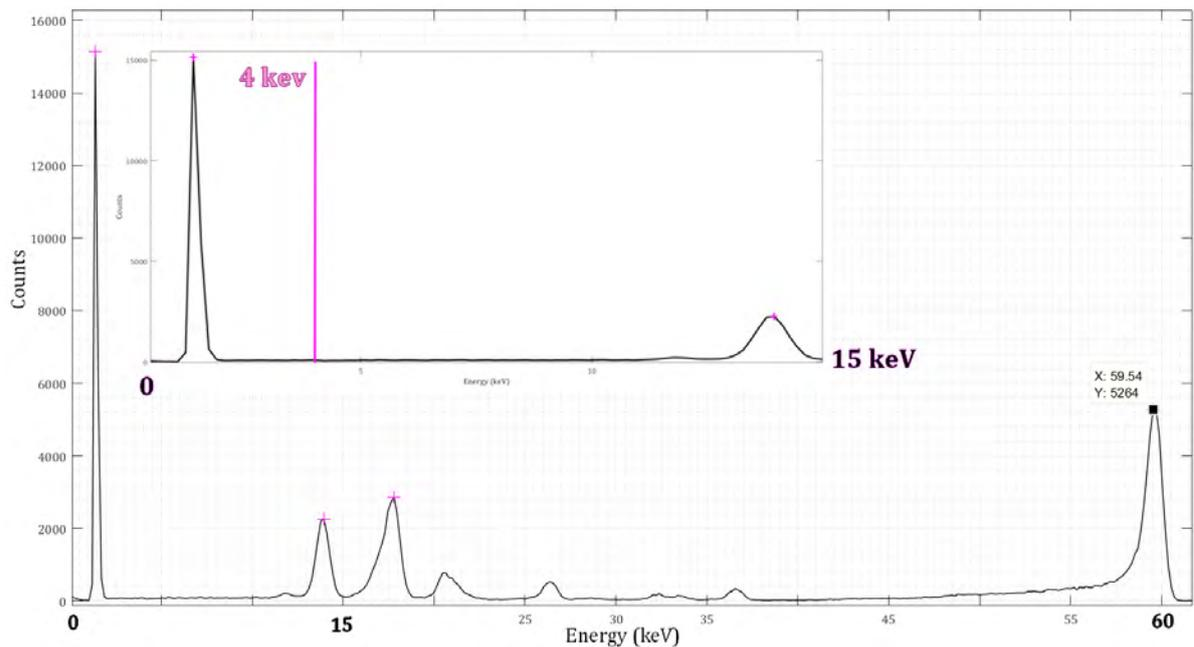
FIGURE 5.5 – Exemple de spectre avec un pic de bruit - Polarisation à  $-300$  V - peaking time à  $2,6 \mu\text{s}$  - Seuil numérique à 8 - Source  $^{241}\text{Am}$ . Le pic de plus basse énergie est le pic de bruit, les autres pics sont les raies X et gamma de la source de  $^{241}\text{Am}$ .
