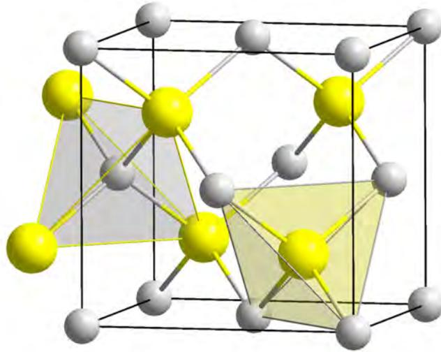
FIGURE 2.19 – Maille élémentaire de la structure cristallographique cubique du CdTe : les atomes de tellure occupent les sites symbolisés par les grandes sphères et les atomes de cadmium par les petites sphères.
