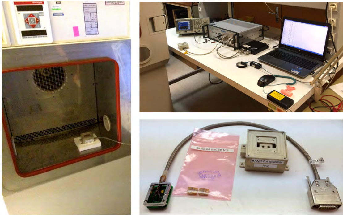
FIGURE 5.12 – Images du banc de test permettant les mesures de gain et de bruit ENC des Céramiques ASIC - Gauche : Enceinte thermique pour la régulation à -20^{\circ}\text{C} dans laquelle est montée le circuit de test d'une « Céramique ASIC » 32 voies / En haut à droite : banc de test électronique connecté à un générateur de signal arbitraire / En bas à droite : Céramique ASIC montée sur son circuit de test comprenant un support mécanique avec maintien par visserie sur tige filetée et câble spécifique pour effectuer l'alimentation, le contrôle et la commande des puces ASIC.
