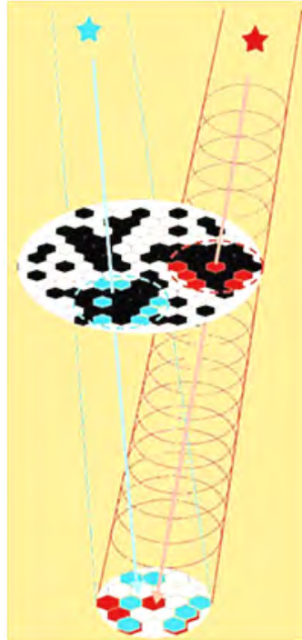
FIGURE 2.26 – Principe du masque codé : chaque source projette l'ombre du masque (correspondant à un motif opaque) sur le plan de détection, qui représente une image avec une forme unique permettant d'identifier la direction et ainsi, l'origine de la source, de manière exacte (après reconstruction par calcul).
