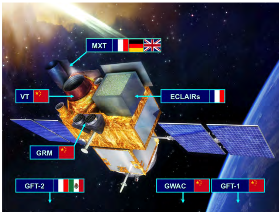
FIGURE 1.12 – Le satellite SVOM comprend quatre instruments spatiaux : deux instruments français, ECLAIRs et MXT (Microchannel X-ray Telescope), et deux instruments chinois, VT (Visible Telescope) et GRM (Gamma Ray Monitor). Credit : CNES
