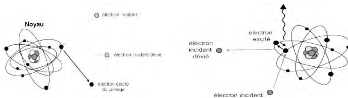
FIGURE 2.9 – Interactions d'un électron incident avec un atome d'un matériau cible - Schéma de gauche : processus d'ionisation, avec l'électron incident qui est dévié (rétro-diffusé) après avoir éjecté de l'atome un électron situé sur une couche interne de celui-ci. / Schéma de droite : processus d'excitation, avec l'électron incident qui est dévié, après qu'un électron orbital est passé sur une couche supérieure. Dans les deux cas, la réorganisation du nuage électronique (l'électron redescend sur une couche inférieure) donne lieu à une émission caractéristique (fluorescence de l'atome ou rayonnement X secondaire).
