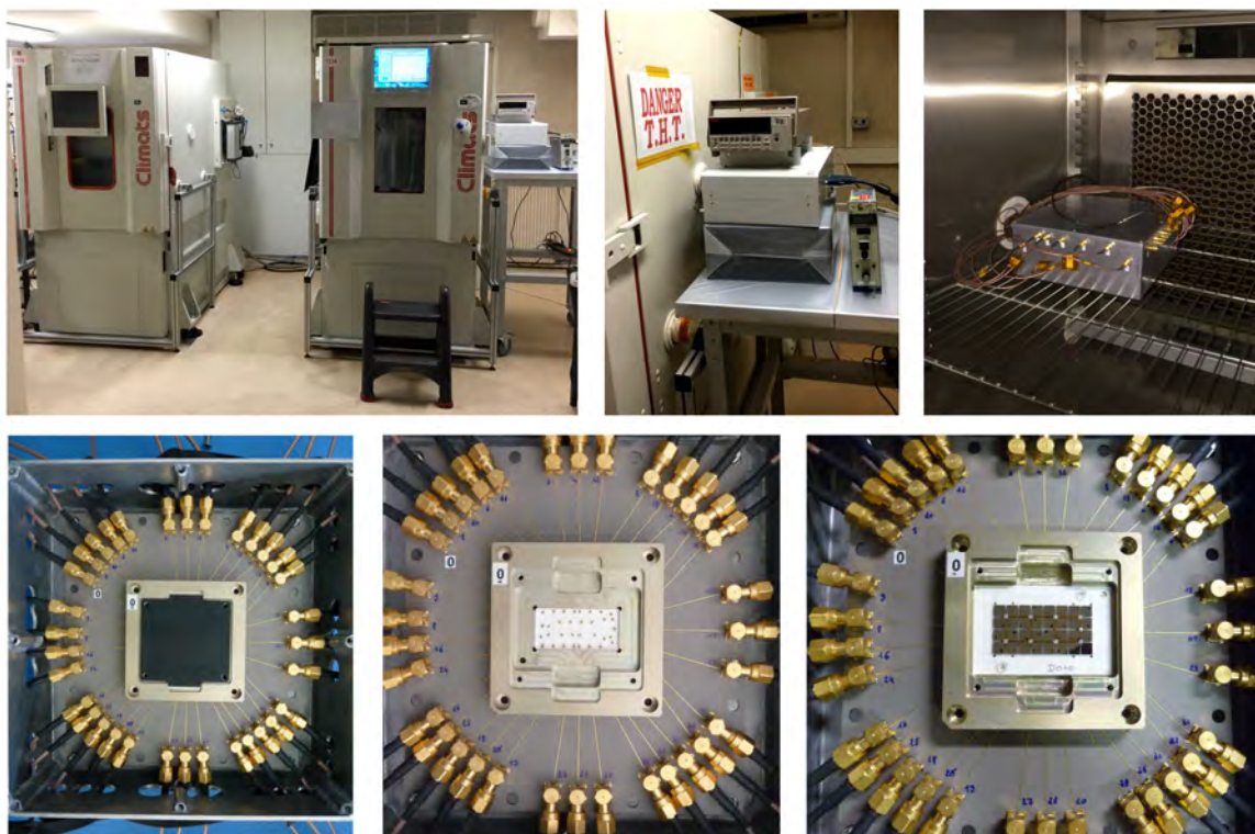
FIGURE 5.7 – Images du banc de test permettant les mesures de courant de fuite - Photo du haut : Enceintes thermiques pour la régulation des basses températures dans lesquelles sont montés les circuits de test des « Céramiques Détecteurs » 32 voies, mesurées au moyen d'un ampèremètre à faible signal, pour des courants de l'ordre du pico-ampère, placé en sortie d'un multiplexeur 32 voies / Photo du bas : Circuit de test des « Céramiques Détecteurs » comprenant un substrat céramique à pointes.
