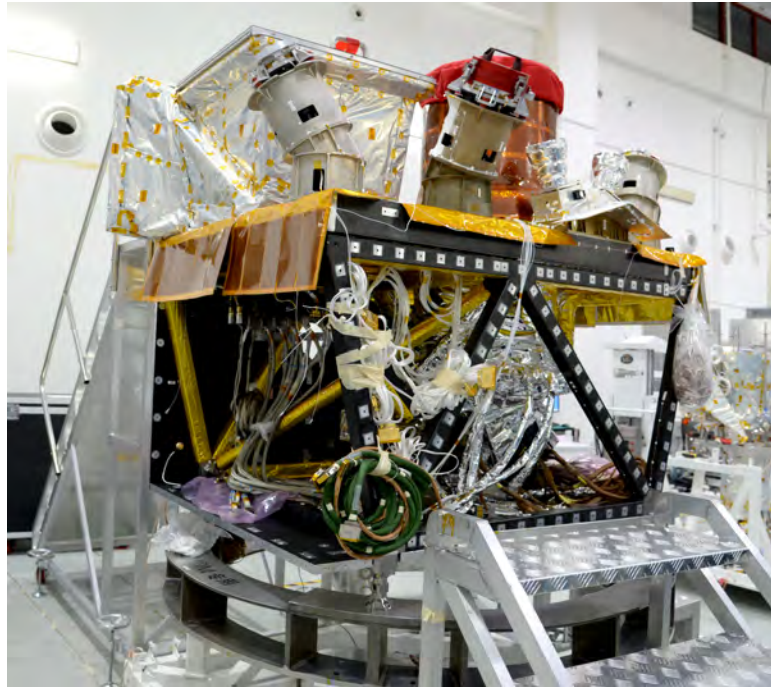
FIGURE 3.2 – Le modèle STM (Modèle Structurel et Thermique) de la plate-forme SVOM, avec quelques-uns de ses instruments en cours de montage. Credit CNES
