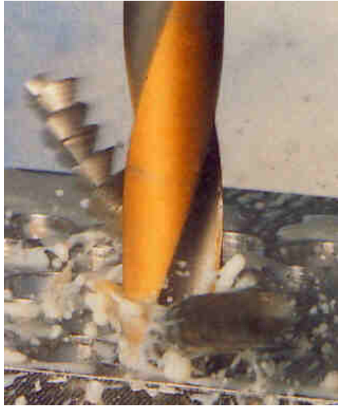
FIGURE 1.4 – Opération de perçage avec lubrification interne
