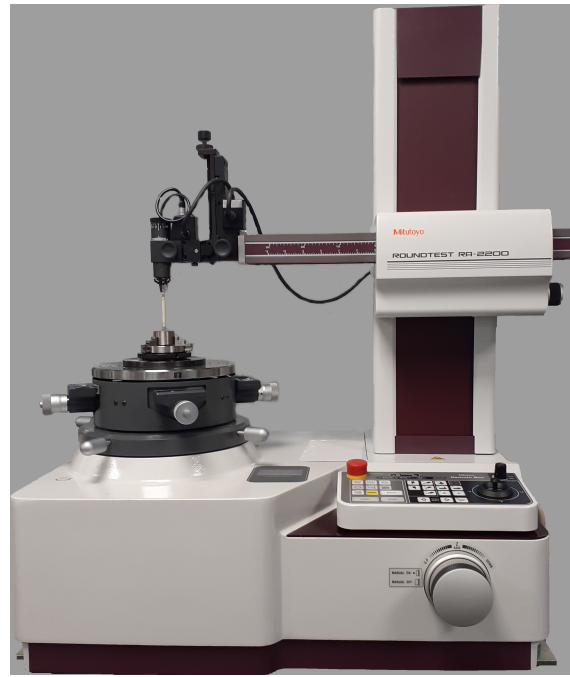
FIGURE 2.4 – Measureur d'écart de forme Mitutoyo RA-2200-DS avec un échantillon à mesurer
