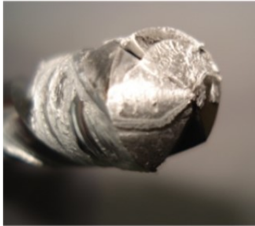
FIGURE 1.2 – Conséquence d'un bourrage des copeaux d'aluminium dans les goujures d'un outil
