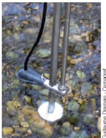
FIGURE 2.14 – Exemple d'un courantomètre électro-magnétique.
