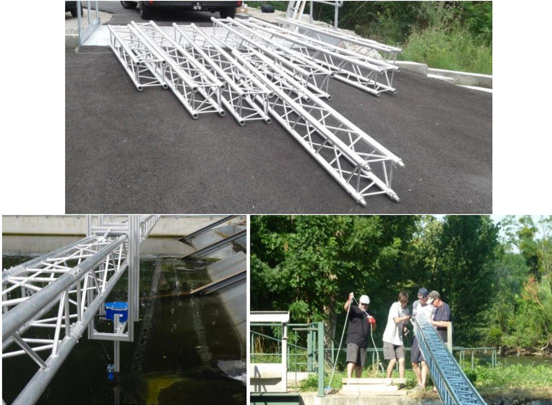
FIGURE 2.11 – Support et chariot de déplacement ayant permis de déployer la sonde ADCP.
