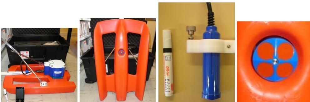
FIGURE 2.10 – Photo de l'ADCP StreamPro monté sur son trimaran et de la sonde avec un détail des 4 capteurs.
