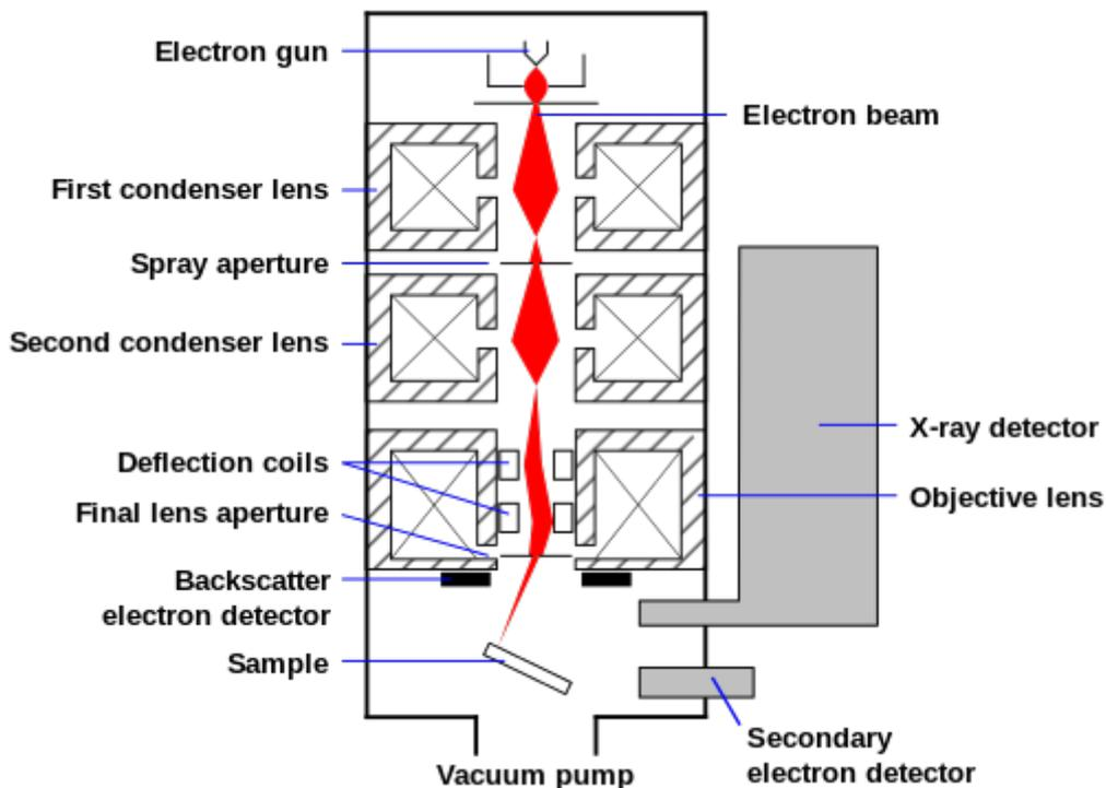
FIGURE 2.3 – Schéma d'un SEM. Les images proviennent de [14].
