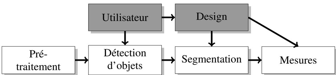
FIGURE 4.2 – Pipeline d'algorithmes pour la mesure automatique d'objets. Les 4 étapes sont représentées en blanc.
