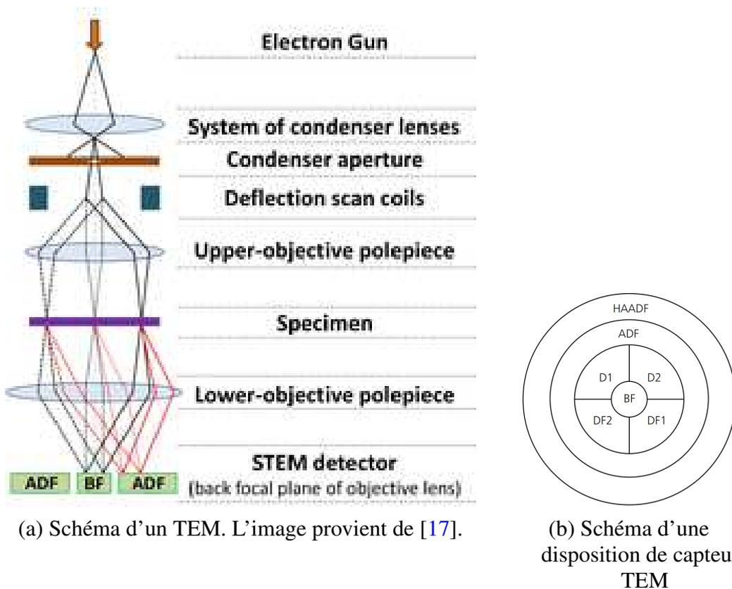
FIGURE 2.6 – Illustration de l'acquisition des modalités TEM et des capteurs.
