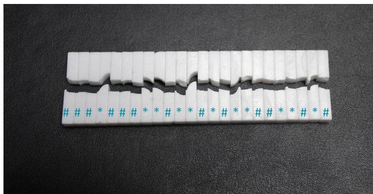
Figure IV-17 : Photographies des éprouvettes de flexion en zircon 3Y 230 frittée par MO sans préparation après rupture. (#) Rupture droite et (*) Rupture déviée
