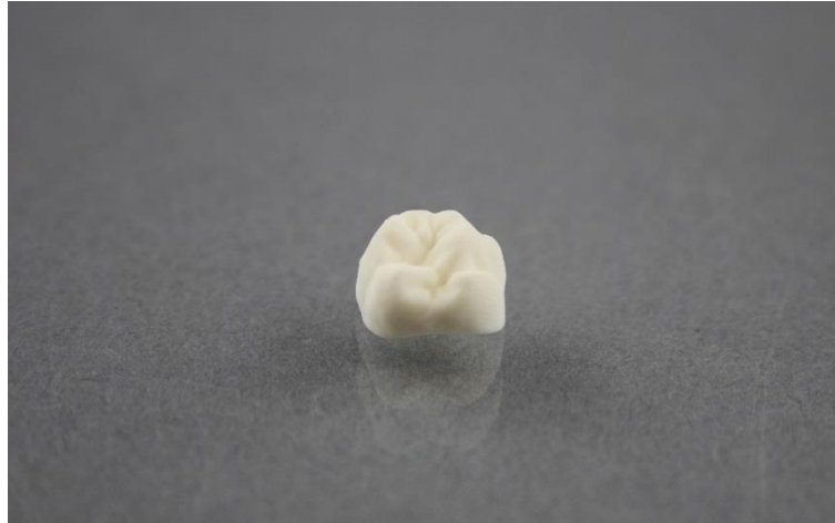
Figure III-40 : Couronne dentaire en alumine imprimée par SLA. Avec l'aimable autorisation du Dr. Dehurtevent pour l'utilisation du fichier STL.
