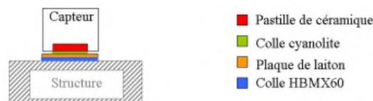
FIGURE 3.1 – Mode opératoire du collage d'un capteur d'EA [14]
