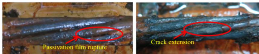
FIGURE 1.16 – Phase 2 : Propagation des fissures [119]
