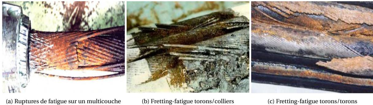
FIGURE 1.5 – Le fretting-fatigue des câbles [20]
