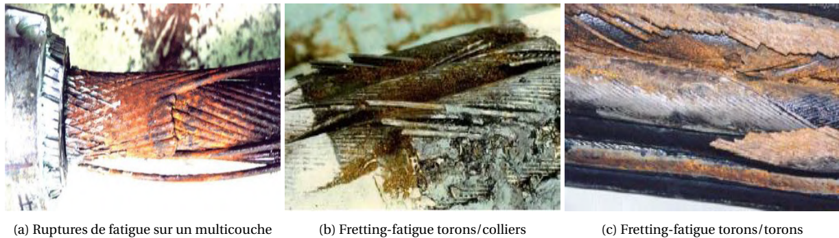
FIGURE 1.5 – Le fretting-fatigue des câbles [20]
