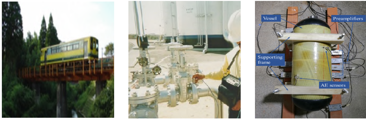
(a) Évaluation des piles d'un pont ferroviaire en béton [102] (b) Détection et évaluation d'une fuite de valve [102] (c) caractérisation d'un vaisseau d'hydrogène en composite sous pression [113]
