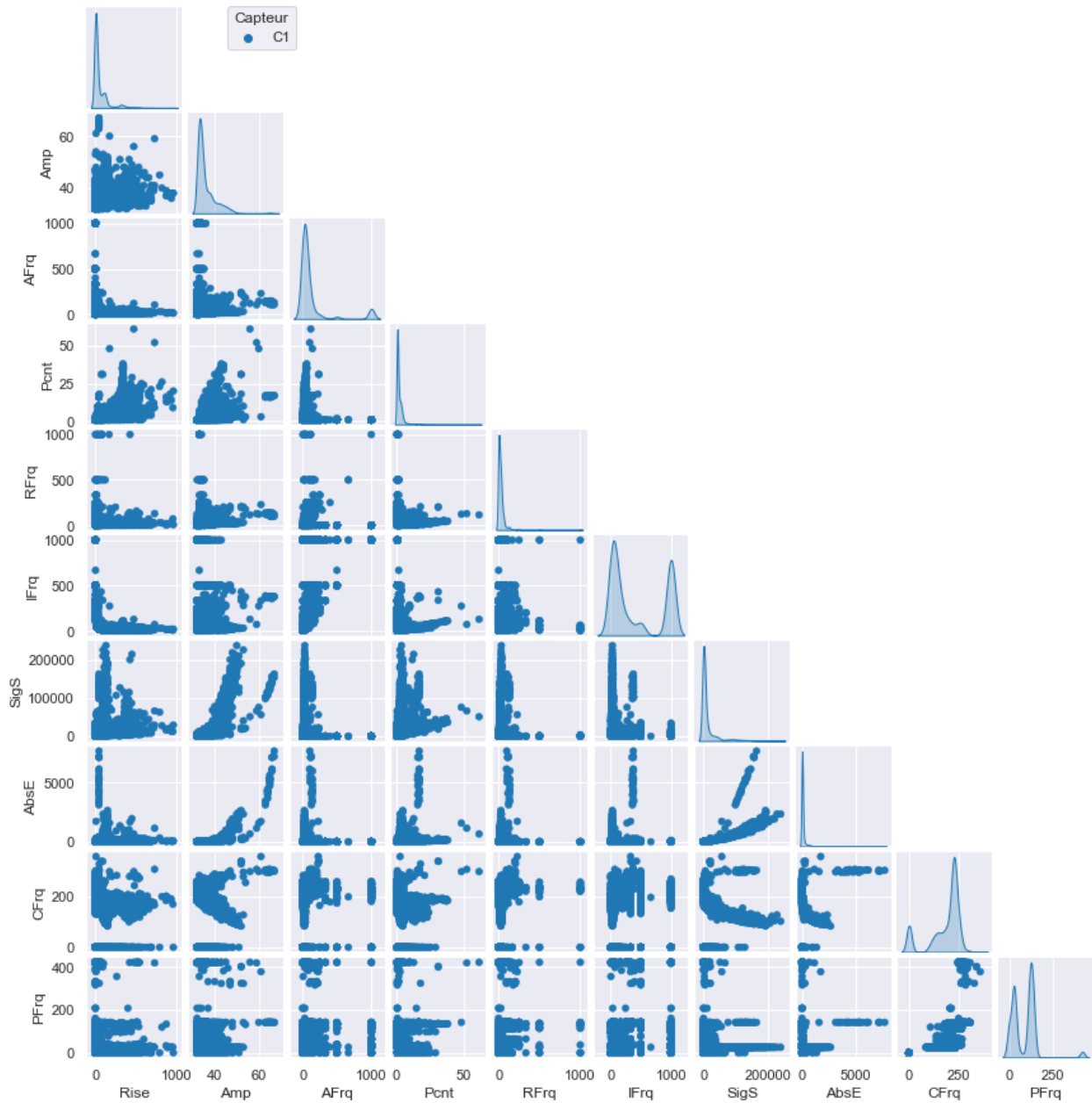
FIGURE 3.44 – Distribution des onze paramètres EA choisis pour les données recueillies aux niveaux de tous les capteurs
