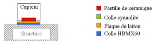
FIGURE 3.1 – Mode opératoire du collage d'un capteur d'EA [14]
