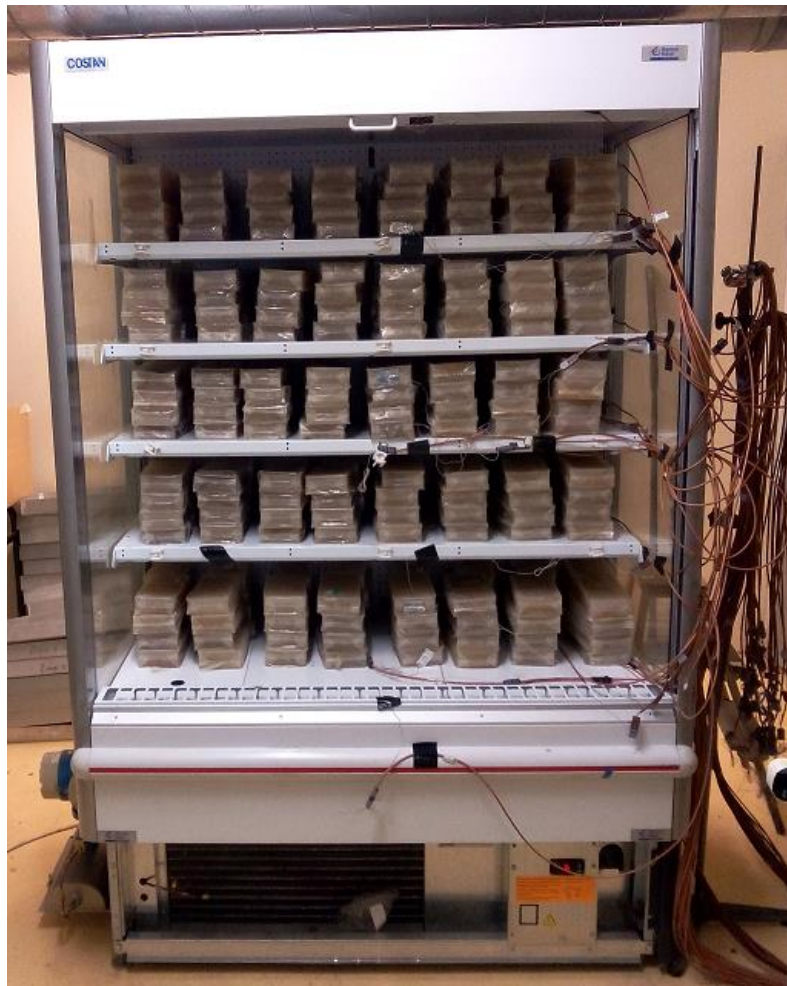
Figure 11 : Meuble ouvert instrumenté avec paquets de méthylcellulose
