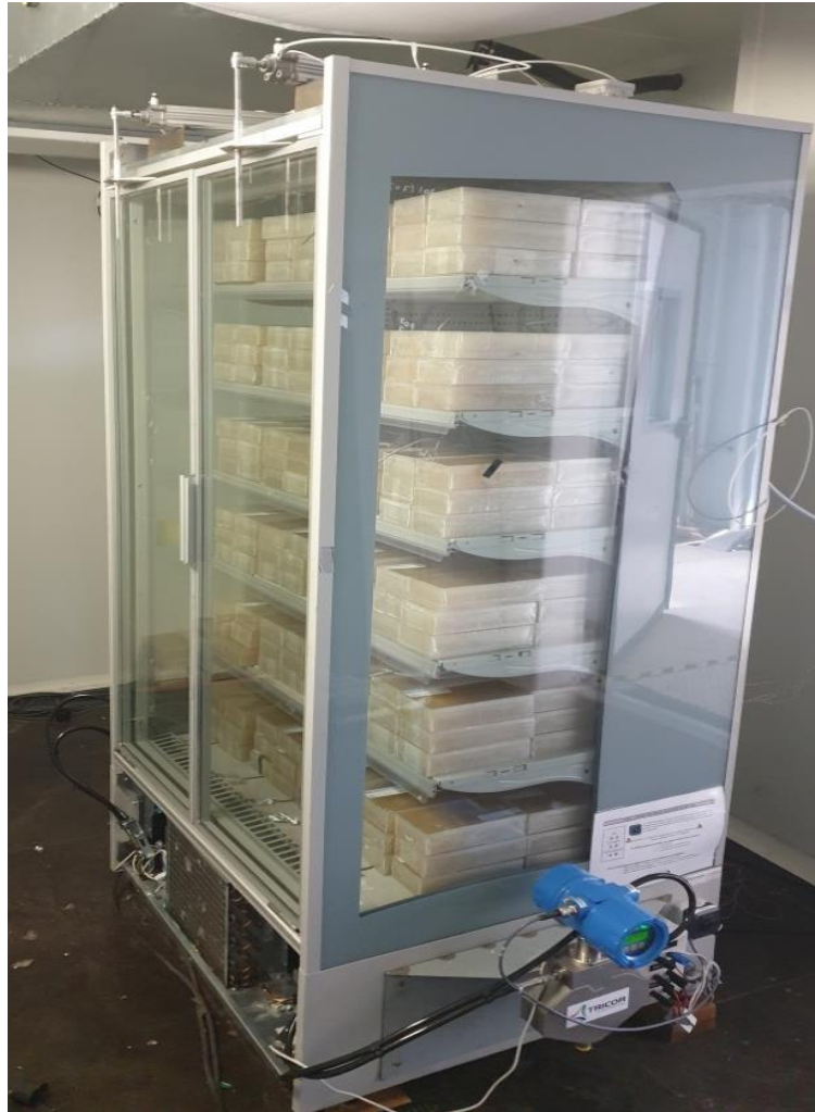
Figure 15 : Photo du meuble frigorifique fermé
