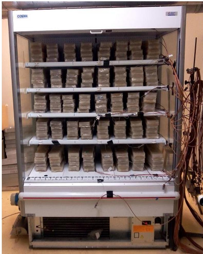
Figure 11 : Meuble ouvert instrumenté avec paquets de méthylcellulose
