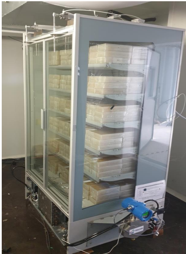
Figure 15 : Photo du meuble frigorifique fermé
