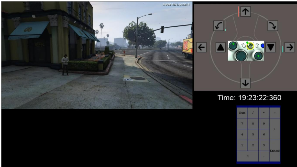
Figure 22 : Ecran enregistré durant la passation. La partie en haut à gauche montre l'écran du participant. Les autres éléments sont visibles seulement de l'expérimentateur : la partie en haut à droite est la fenêtre de visualisation des mouvements du 3D Rudder . En bas à droite, l'heure est enregistrée et les appuis du participant sur le clavier de la tâche interférente s'affichent en temps réel.
