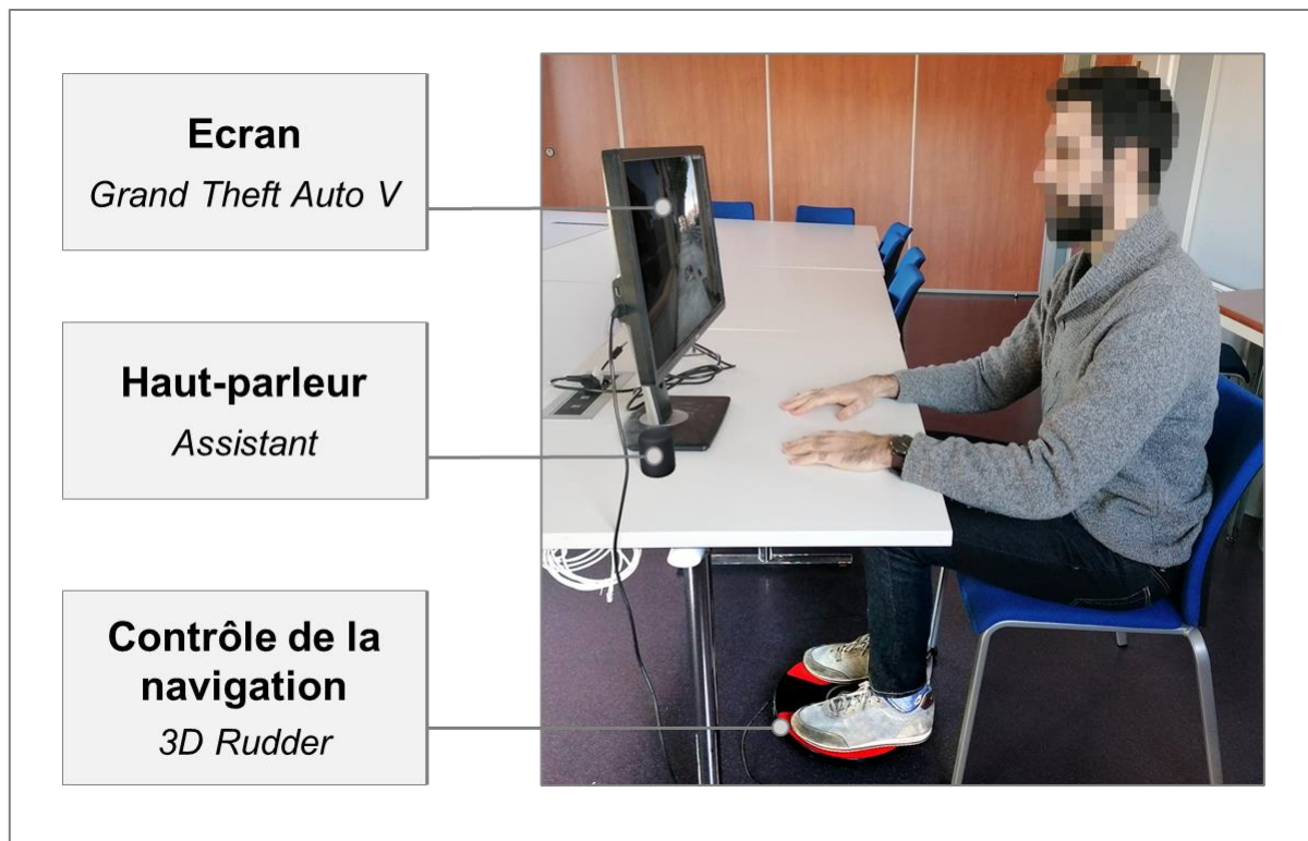
Figure 19 : Configuration pour le participant lors de la passation. Le participant était assis et utilisait la plateforme 3D Rudder sous ses pieds pour se déplacer dans l'environnement virtuel. L'écran devant lui affichait l'environnement de son point de vue. Les instructions de l'assistant à la navigation étaient données par l'intermédiaire du haut-parleur.
