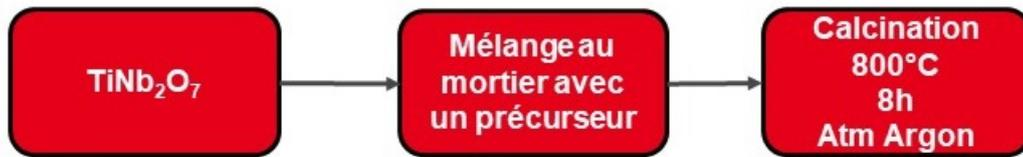
FIGURE III.27 – Procédé de synthèse optimisé du composite  $\text{TiNb}_2\text{O}_7/\text{C}$
