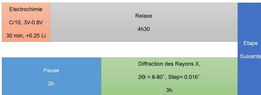
FIGURE II.4 – Résumé du programme de mesure de diffraction des rayons X *in situ*
