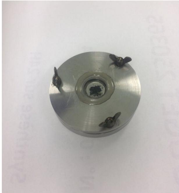
FIGURE V.23 – Cellule pour l'analyse de composé sensible à l'air en spectroscopie Raman
