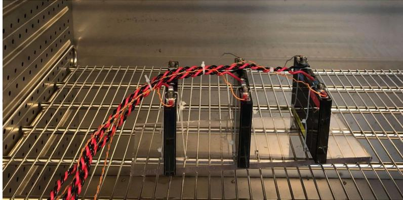
FIGURE 3.1 – Positionnement des LIC vieillies en calendrier dans la chambre thermique, exemple des cellules 2300-30
