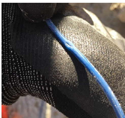
Figure II-109 La fibre poinçonnée à la cote 25,5 NGF
