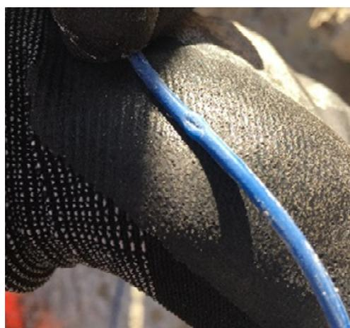
Figure II-109 La fibre poinçonnée à la cote 25,5 NGF
