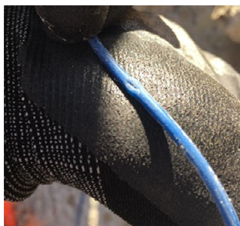
Figure II-109 La fibre poinçonnée à la cote 25,5 NGF
