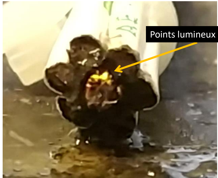
Figure 5.23 : mise en évidence des points lumineux lors de la phase dite de « grésillement ». Conditions expérimentales : U_{atim} = 270\text{VDC} , I_{max} = 10\text{A} - Configuration anode au centre.
