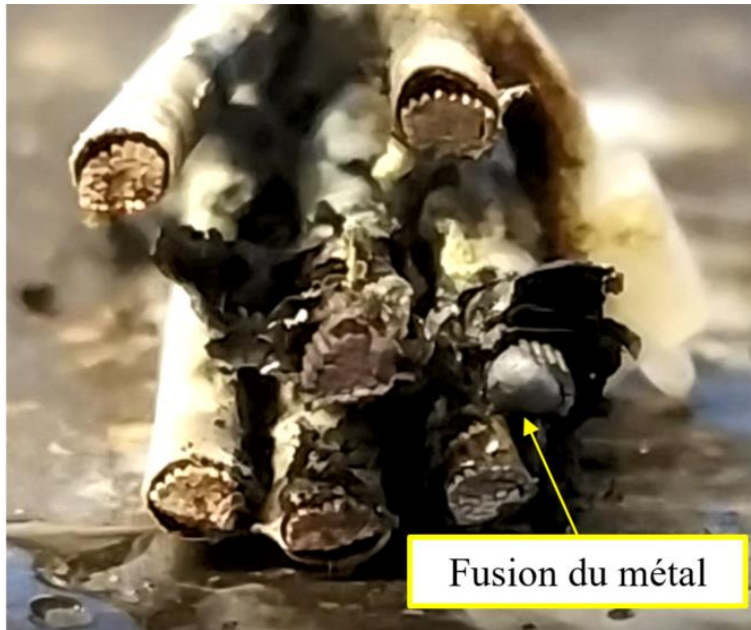
Figure 5.47 : photographie de l'échantillon après l'arrêt de l'essai, avec fusion du métal suite au point chaud.
