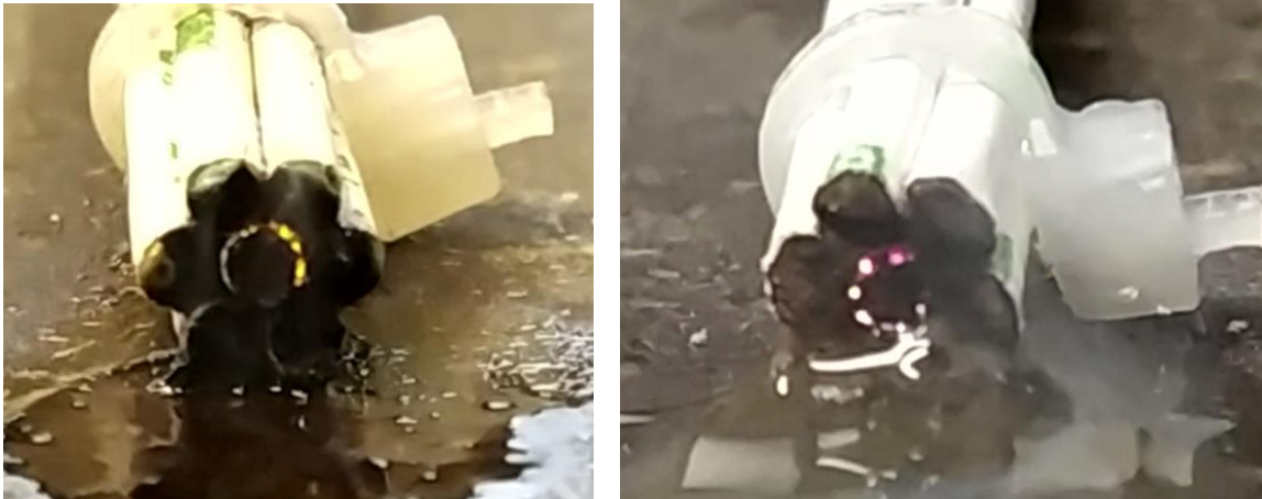
Figure 5.35 : photographie de la fin de la deuxième étape où les points lumineux sont nombreux et forment des arcs de cercles autour de l'électrode centrale. Configuration cathode au centre à gauche et configuration anode au centre à droite. Conditions expérimentales : U_{alim} = 50 VDC, I_{max} = 20 A
