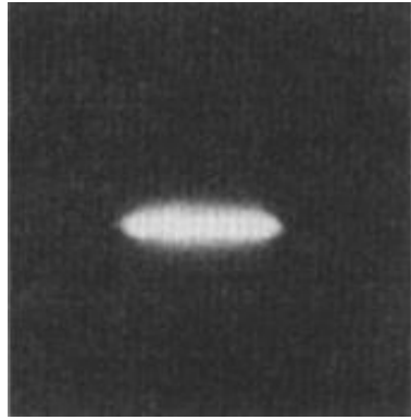
Figure 4.13 (à gauche) : photographie d'un arc entre deux électrodes d'aluminium. I = 10 \text{ A} , d = 100 \text{ mm} - Photographie prise 10 ms après l'amorçage del'arc (extrait de Stokes et al.).
