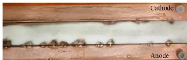
Figure 2.4: photographie des dommages laissés par l'arc au niveau des électrodes. On aperçoit les nombreux points d'ancrage du pied anodique ainsi que la trace continue laissée au niveau de la cathode (extrait de Gray et al. 9,10 ).
