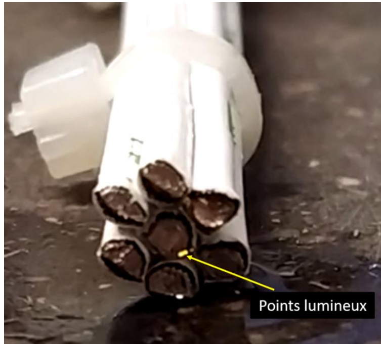
Figure 5.22 : mise en évidence des points lumineux lors de la phase dite de « grésillement ». Conditions expérimentales : U_{alim} = 100\text{VDC} , I_{max} = 10\text{A} – configuration cathode au centre.
