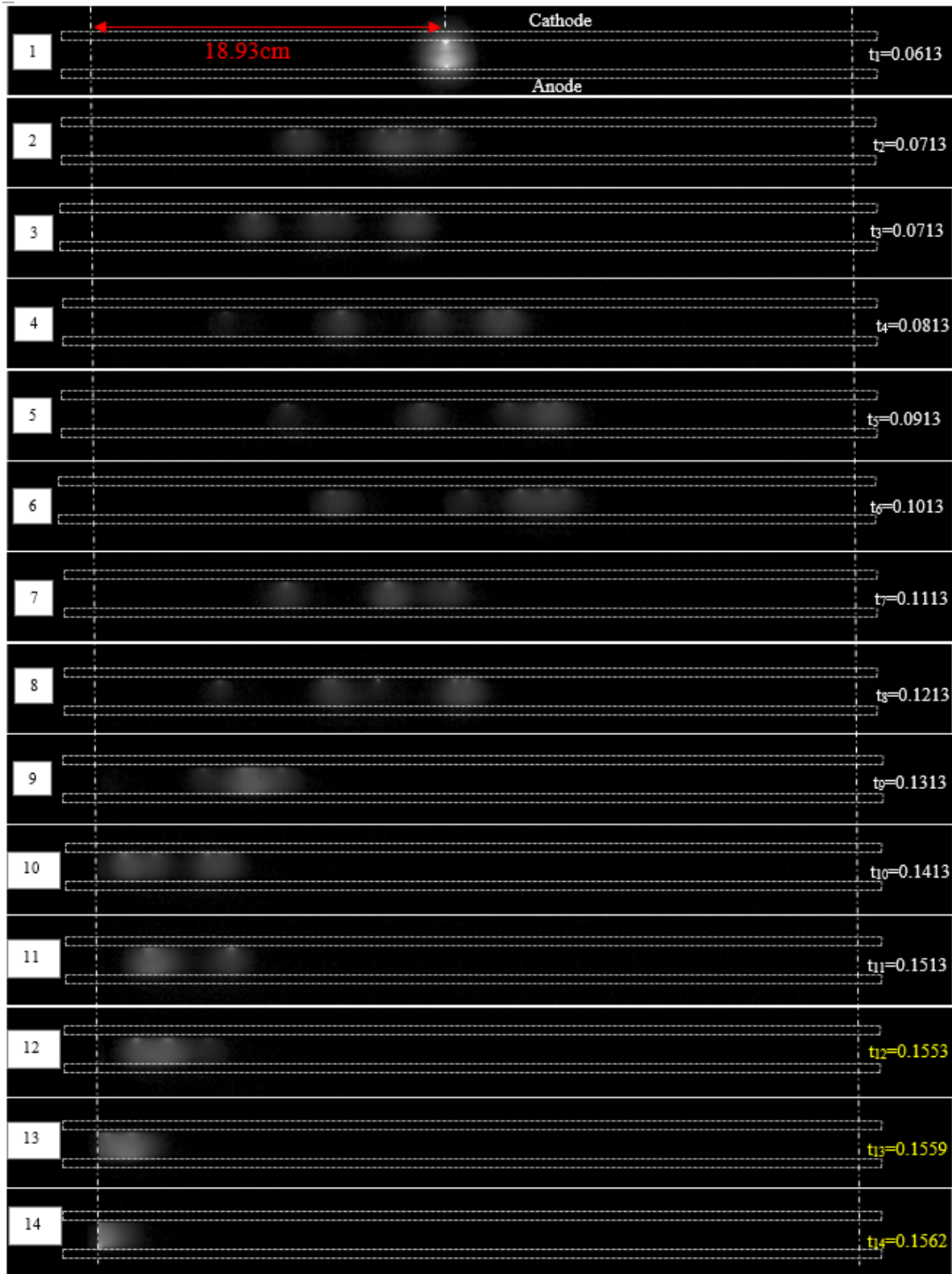
Figure 2.33 : déplacement de l'arc entre les deux barreaux en cuivre.
