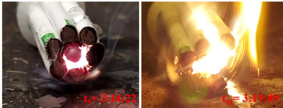
Figure 5.67 : photographies d'un point chaud à gauche et d'un départ de feu accompagné par un point chaud à droite, l'état final est un court-circuit par pont fondu. Les conditions expérimentales : U_{alim} = 490 VDC, I_{max} = 10 A, polarité anode au centre.
