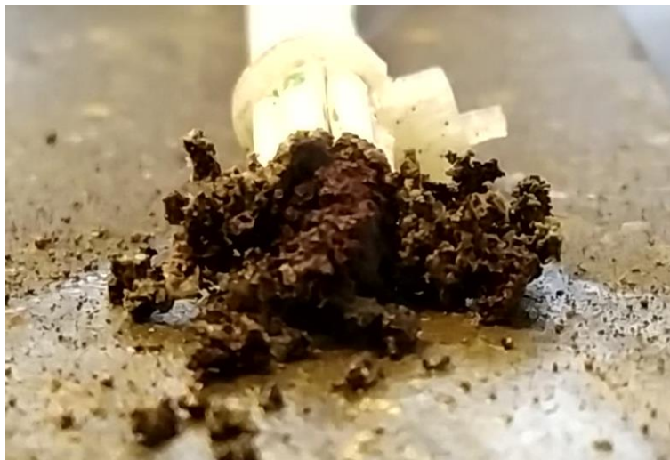
Figure 5.41 : photographie de l'état de dégradation de conducteur sous l'effet du grésillement. Conditions expérimentales : U_{alim} = 50 VDC, I_{max} = 20 A, configuration cathode au centre.
