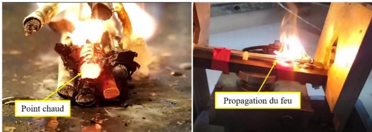
Figure 5.46 : photographie d'un point chaud accompagné par un départ de feu. Conditions expérimentales : U_{dim} = 100 VDC, I_{max} = 10 A, configuration cathode au centre.
