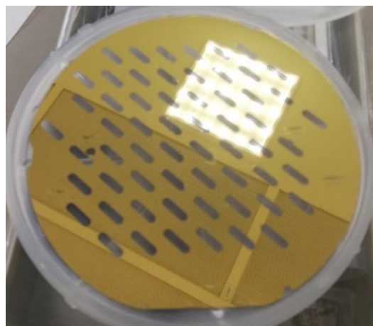
Figure 5-4 : wafer d'aluminosilicate après le dépôt d'or et avant sa découpe à la scie à fil.
