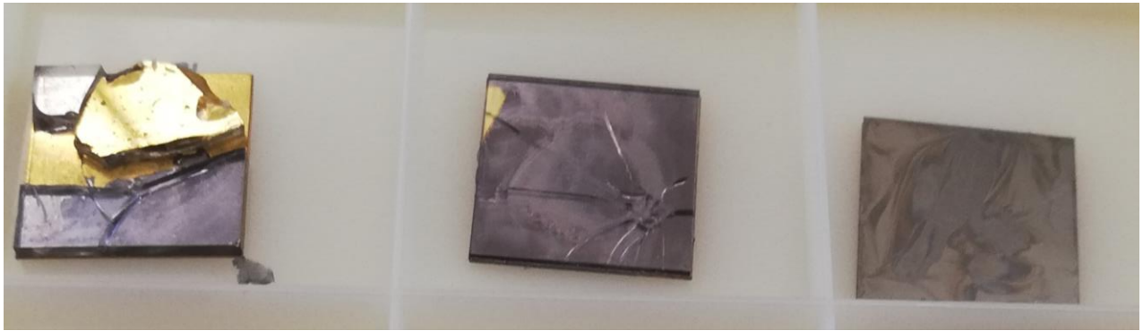
Figure 2-16 : photographies des puces après retrait de l'acétone. A gauche, essai Ti/borosilicate. Au milieu essai Ti/aluminosilicate. A droite, essai Ti/Ti.
