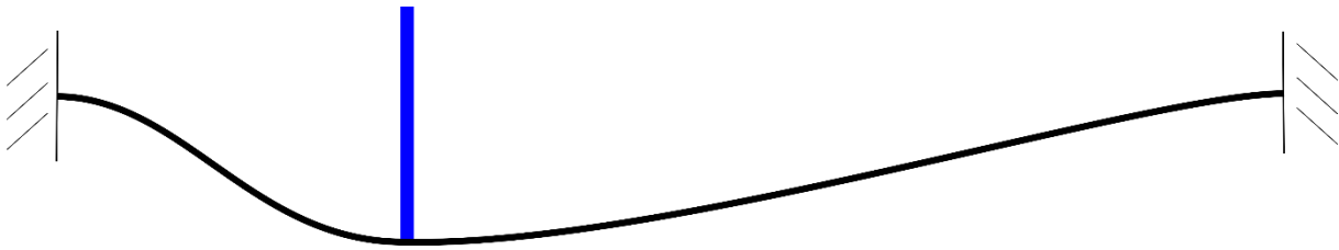
Figure 4-39 : principe de la mesure de cartographie de raideur. La force est successivement appliquée ponctuellement en tout point sur la membrane.
