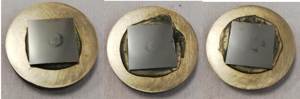
Figure 2-14 : essais après le test en traction. A gauche, bonding Ti/borosilicate. Au milieu, bonding Ti/aluminosilicate. A droite, bonding Ti/Ti.
