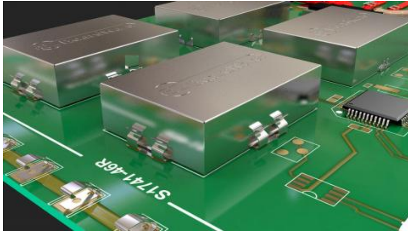
Figure 77 : Capot d'isolation pour l'implantation du via Shielding
