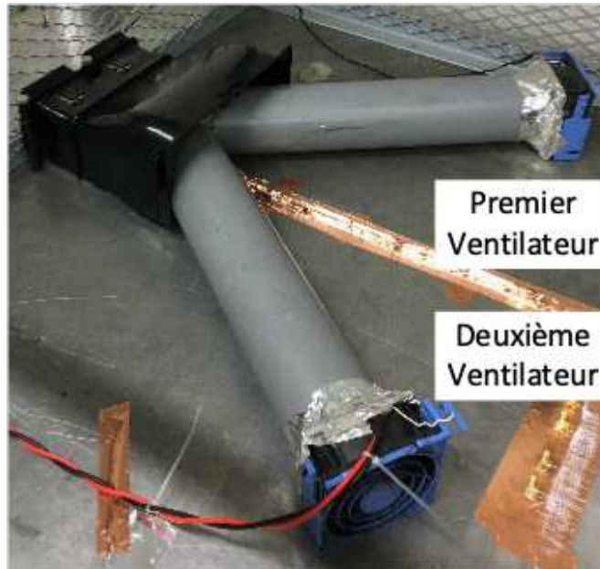
Figure 199 : Placement des ventilateurs pour la stabilisation de la température du stator
