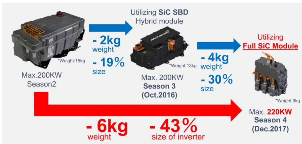
Figure 4 : Évolution d'un module électrique en SiC [6]
