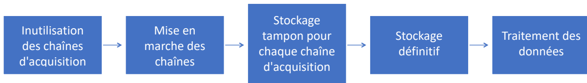
Figure 36 : Diagramme fonctionnel de l'utilisation de l'entité acquisition
