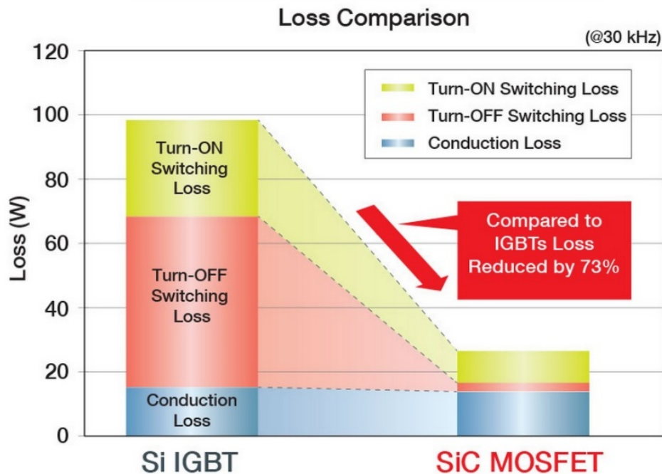
Figure 19 : Comparaison des énergies perdues à la commutation et à la conduction entre un IGBT Si vs MOSFET SiC [43]-
