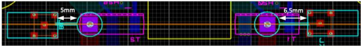
Figure 89 : Différence de longueur sur les longueurs de piste les sondes de champs proches
