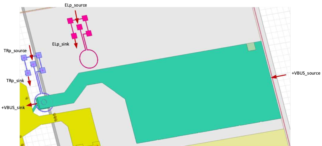
Figure 86 : Placement des sources et des sinks sur le solveur Q3D en fonction des plans de puissance et des deux types de sondes
