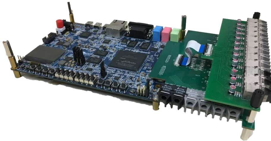
Figure 157 : Assemblage de la carte interface, carte fille et platine de développement SoC-Kit
