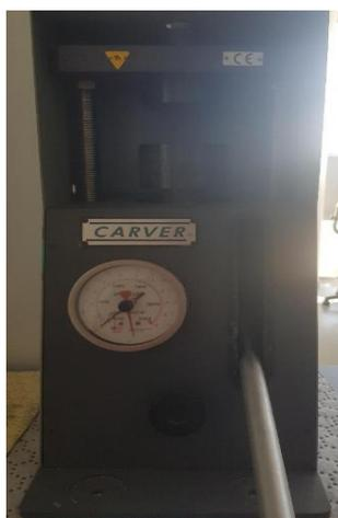
*Figure II.12 : Appareil d'obtention de pastilles de verres par compression*
