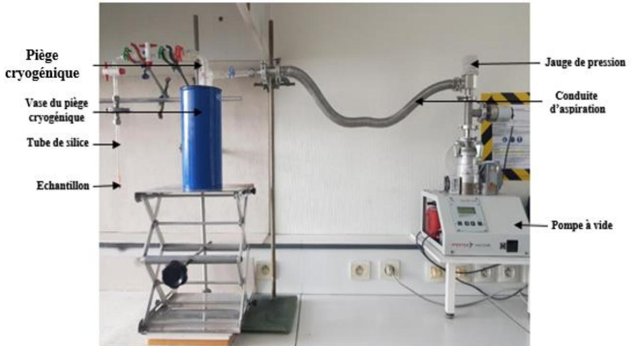
*Figure I.5 : Banc expérimental et d'essai de laboratoire LPCA utilisé pendant la synthèse des verres*
