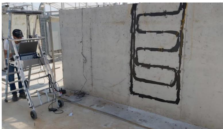
Figure IV-24 : Photo prise lors d'une interrogation du câble Neubrex en surface du Bloc KB .
