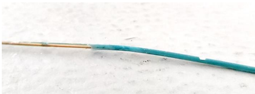
Figure III-36 : Etat de la surface externe du câble AFL arraché manuellement du cylindre de béton après 9 mois de vieillissement en solution alcaline à 60 °C.
