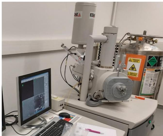
Figure II-30 : Equipement MEB-EDX utilisé dans le cadre de l'étude.
