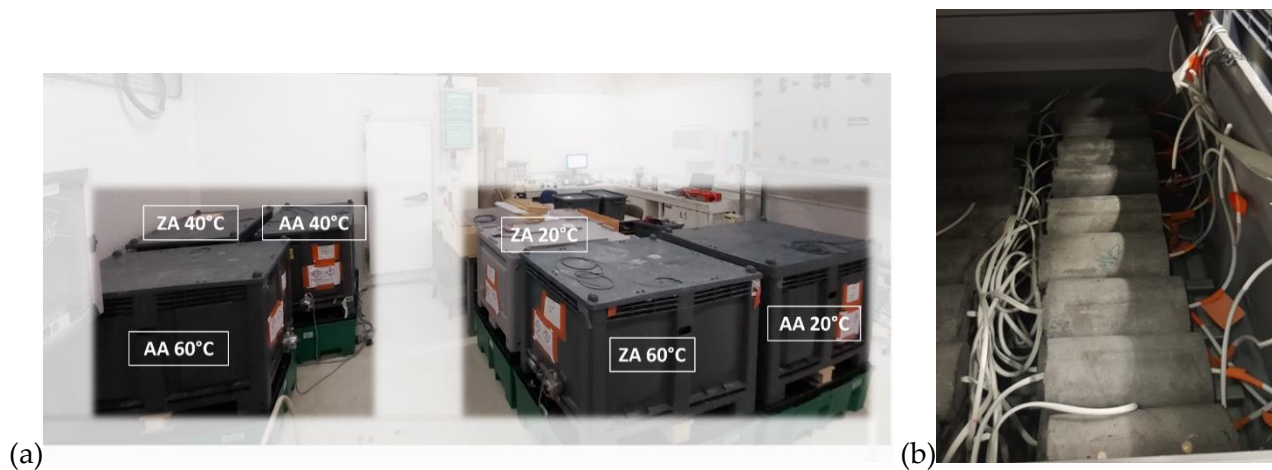
Figure II-33 : (a) Bacs thermo-régulés destinés au vieillissement des éprouvettes en solution alcaline; (b) Stockage des éprouvettes dans un bac avant immersion et après mise en place d'une protection des sorties de câbles à l'aide d'une gaine en PVC.
