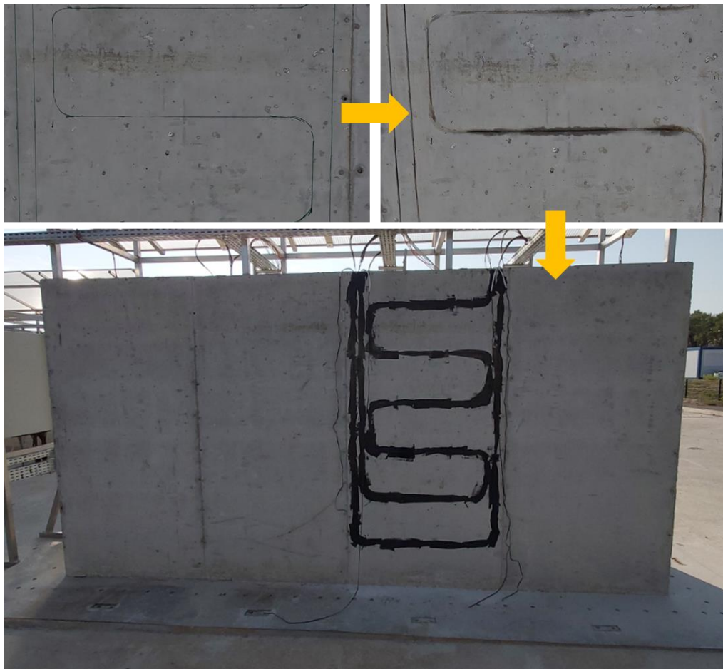
Figure IV-21 : Instrumentation du Bloc KB en surface avec le câble Neubrex : parcours tracé, parcours rainuré et câble collé.
