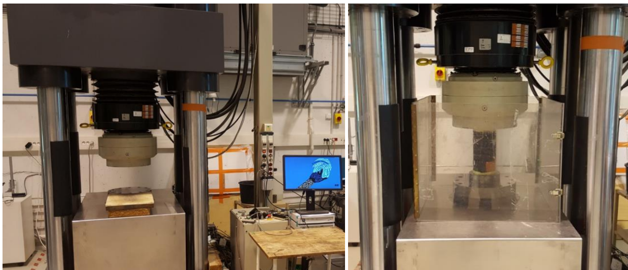
Figure II-15 : Presse de capacité 5000 kN utilisée pour la réalisation des essais de compression.
