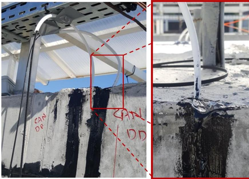
Figure IV-22 : Protection des sorties du câble Neubrex collé en surface du Bloc ZA à l'aide de gaines en PVC.
