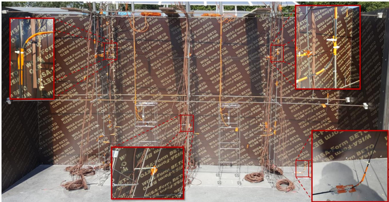
Figure IV-17 : Instrumentation du Bloc IB non armé avec le câble Neubrex noyé.
