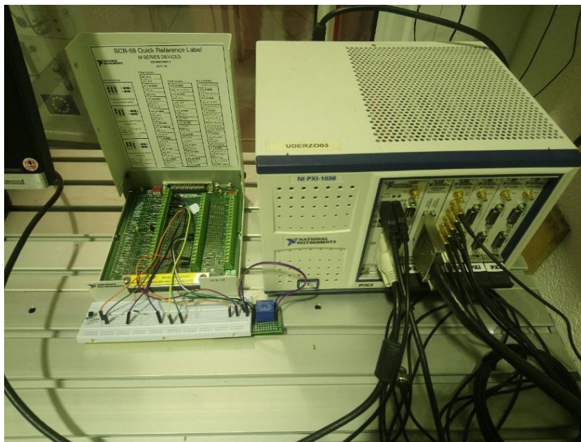
Figure II. 16 : Centrale de contrôle de National Instruments pour les acquisitions acoustiques, le contrôle des systèmes de déplacement et du débit d'air sortant de la buse du jet.
