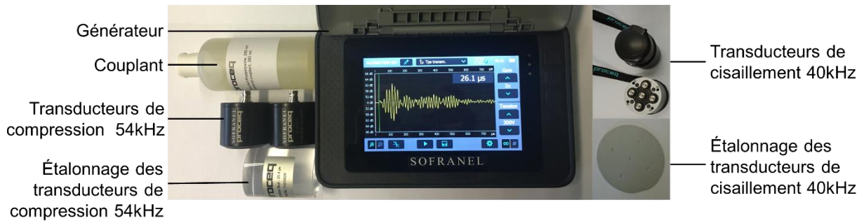
Figure III-22 : Pundit PL-200 et transducteurs
