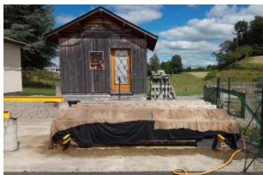
Figure III-9 : Système d'arrosage pour des quatre poutres CND
