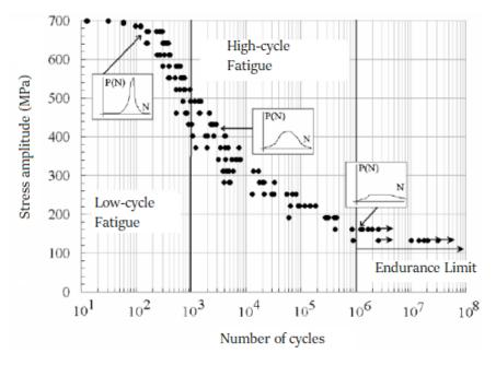
Figure 1.2 – Schéma d'une courbe de Wöhler
