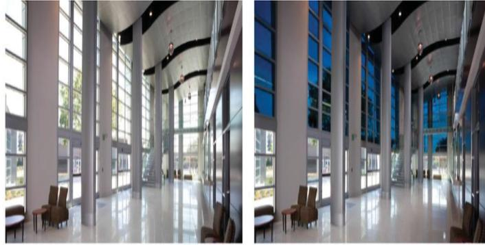
Figure I.6 : Exemple d'une fenêtre électrochrome aux deux états coloré et transparent commercialisée par SageGlass.
