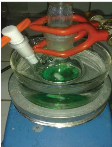
Figure II.2 : La solution préparée à partir de l'acétate de nickel dans le méthanol en utilisant le triton X 100 comme stabilisant.
