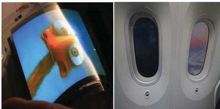
Figure I.9 : Afficheurs et hublots électrochromes dans un avion Boeing [77].
