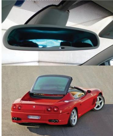
Figure I.8 : les rétroviseurs et les toits électrochromes [73].
