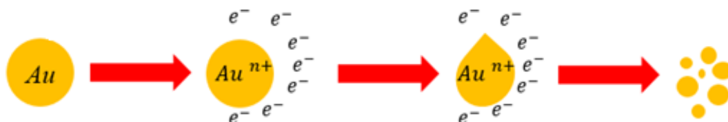
Fig. 1.9 : Fragmentation de la NP par l'explosion coulombienne.
