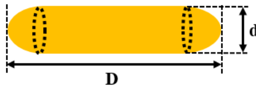
Fig. 2.11 : Schéma et définition des paramètres géométriques d'un nanobâtonnet.
